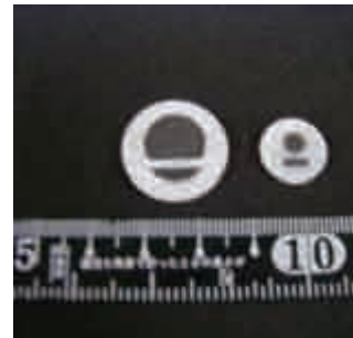
図3: 新型燃料電池の単セル写真
