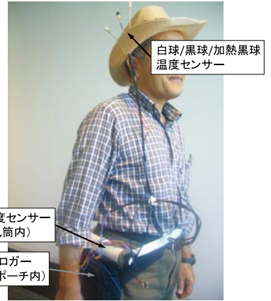
図3：人体装着型の小型気象要素計測装置
