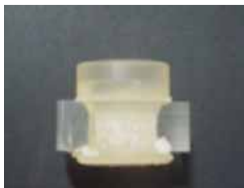
Fig. 7 摩擦後試験片 (全体)
