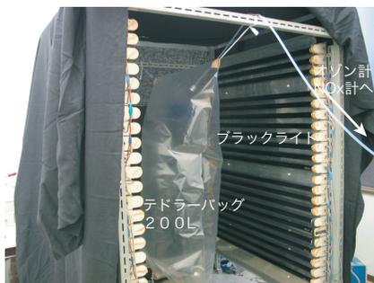
図 3: 紫外線照射装置
