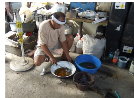
左の写真と同じ業者。使用済み製品を解体し、外した部品を煮詰めて、金を採取する。
